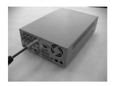
2. 製品からカバーを取り外します。(カバーは、少し後ろ側にスライドさせてから、先に少し後ろ側を持ち上げて外します。)
